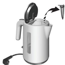
2. Ağı filtreyi temizlemek için,, süzgeç takacığını tutun ve kaldırarak dışarı çıkartın. **Resistansın temizlenmesi**
